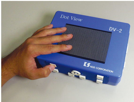
図 1 点図ディスプレイ A tactile display.
