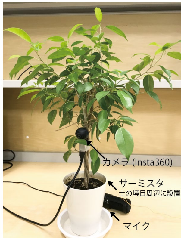
図16 観葉植物側に設置するセンサー類
