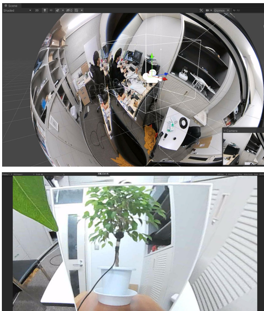
図18 Insta360 Airより取得した映像をUnity内の球状オブジェクトにテクスチャマッピングし、HMDへ表示する(上図:Unity内の球状オブジェクトにInsta360 Airから取得した映像をテクスチャマッピングした状態、下図:その状態をHMD上で視認した時の画面)
