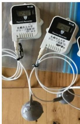
図 3-3 ピンポン玉を灰色（つや無し）に着色して自作した小型灰色球温度計
