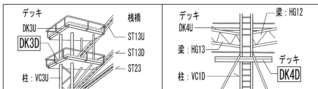
図 4-12 接続部材の数え方の例
