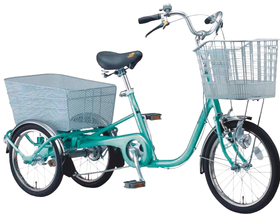
図2 前1輪、後2輪タイプの市販車両 (パナソニック三輪自転車からやか)
