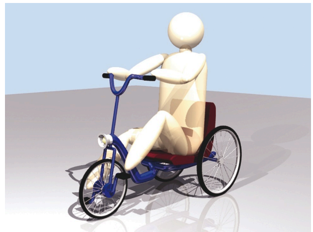
図 6-5 座面を低く、椅子を大きくした案
