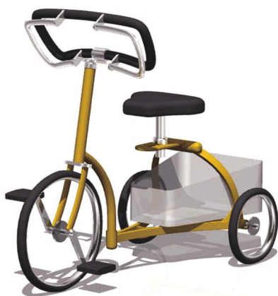
図 6-3 ハンドルを大きく、椅子を跳ね上げる案
