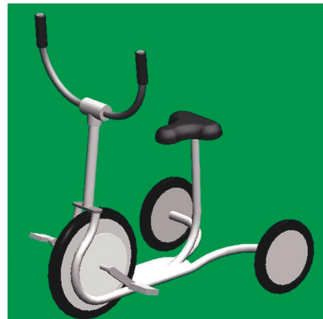
図 9 ハンドルを切ると後輪が動くようにした案
