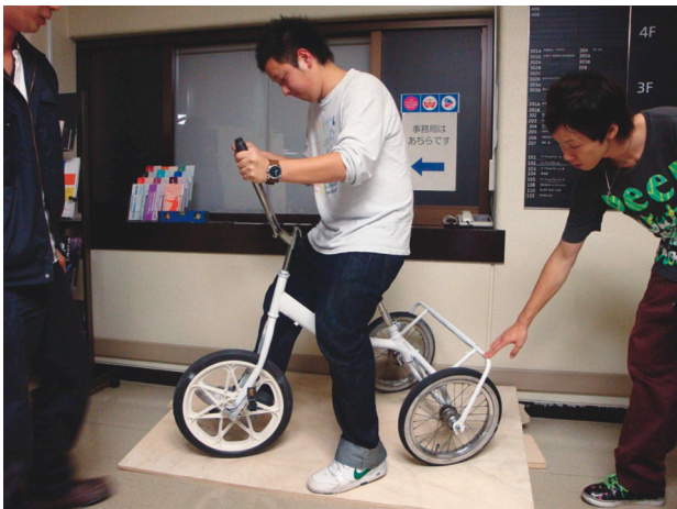
図 7 簡易試作車で傾き角 10 度での転倒実験
